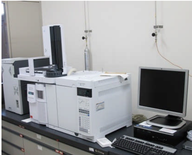
加熱脱離装置付き ガスクロマトグラフ質量分析計 (GC/MS)
